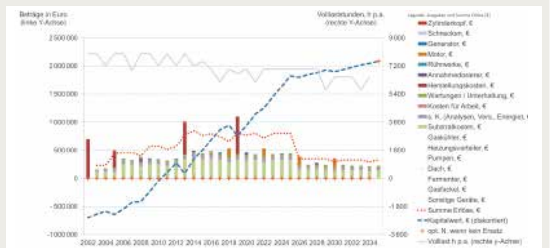
Wirtschaftlichkeit der Biogasanlage 1 (mit Gülle/Reststoffen und Wärmenutzung)
